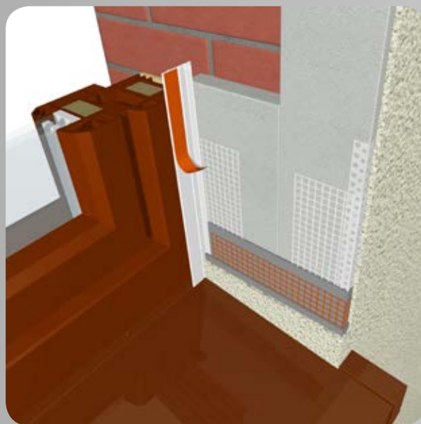
Rysunek 7. Wykończenie połączenia stolarki otworowej z ociepleniem (przy pomocy listwy przykiennej z uszczelką)
