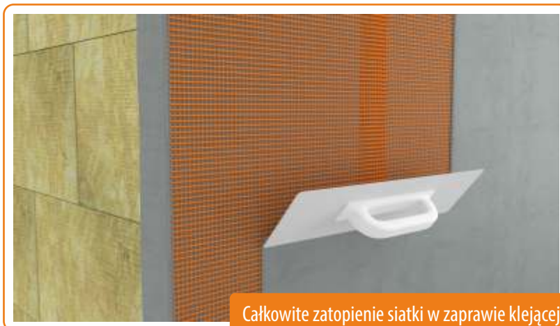
Zakład min 10 cm siatki zbrojącej
